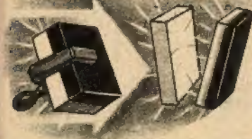
Fig. 2 — O placă de aur este bombardată cu neutroni; după ce placa devine radioactivă se pune în contact cu o placă neradioactivă. După ceva timp se constată că și a doua placă conține izotopi radioactivi.
